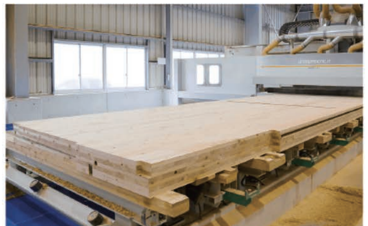
▲製造上最も大きい12m×3mのパネル
