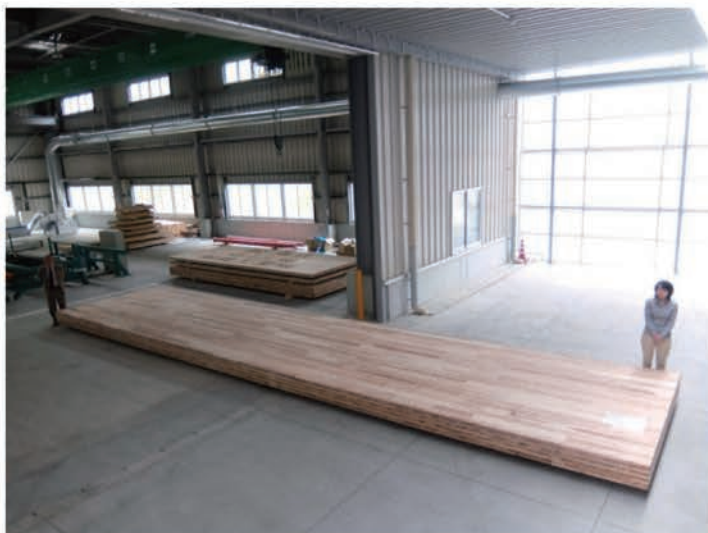
▲製造上最も大きい12m×3mのパネル
